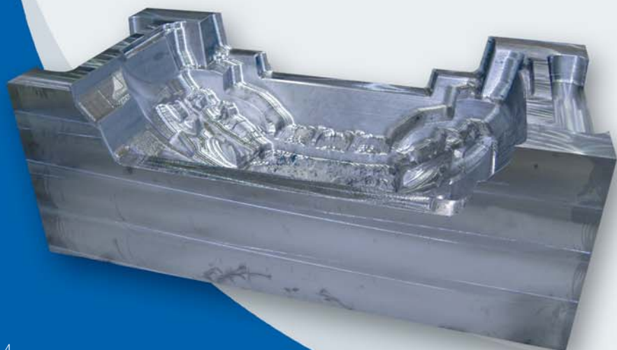
Черновая обработка по спиральной траектории
